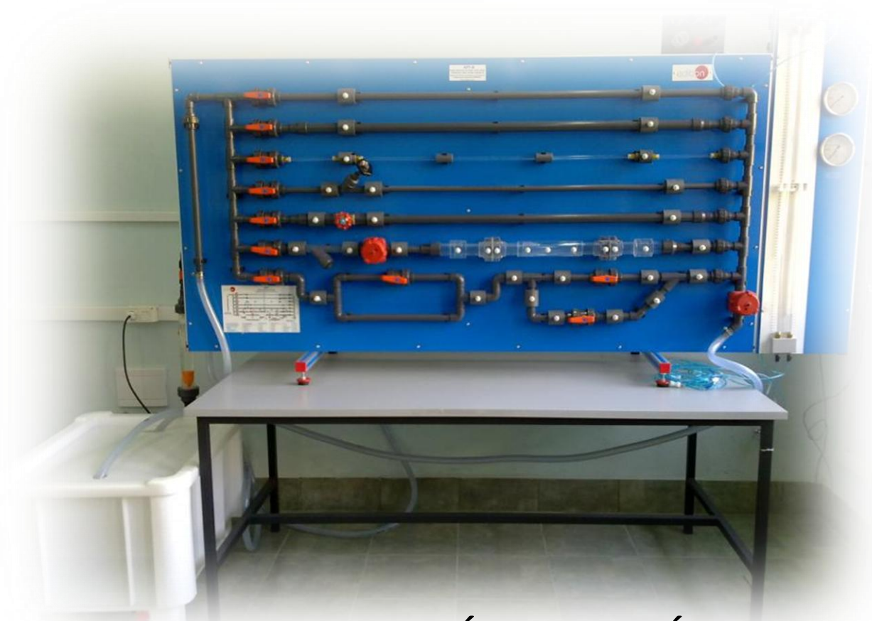
EQUIPO DE FRICCIÓN EN TUBERÍAS CON GRUPO DE ALIMENTACIÓN HIDRÁULICA (FME00/B) AFT/B
